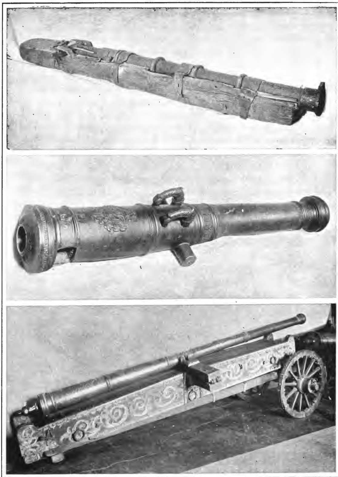
ЖЕЛЪЗНОЕ, ЗАРЯЖАЮЩЕЕСЯ СЪ КАЗЕННОЙ ЧАСТИ ОРУДИЕ НАЧАЛА XV СТ. НАРЪЗНАЯ, ЗАРЯЖАЮЩАЯСЯ СЪ КАЗЕННОЙ ЧАСТИ МЪДНАЯ ПИЦАЛЬ 1615 г. ЖЕЛЪЗНАЯ ПИЦАЛЬ ВИНТОВОЙ СИСТЕМЫ XVII СТ. НА СТАНКЪ ТОГО-ЖЕ ВРЕМЕНИ.
